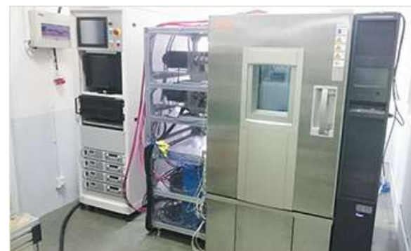
車載用ブラシレスモーター 「耐久試験機(恒温槽付)」 最大6台のモータを同時評価 可能な試験効率の良い装置
