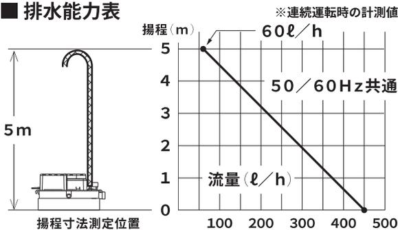
MIDO-NP20WS2-Hが使用できる空調機は、28kw(10馬力)までの一般空調機です。28kwのオールフレッシュエアコン、大型エアハン等はドレンポンプの排水能力を超える量のドレンが発生するため、長時間運転となりご使用できません(排水性能表はドレンポンプの連続運転時の最大排水量を表しています。28kwまでの一般空調機でのご使用時にご参照ください)。
