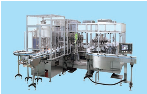
スイスボトル袴レス搬送充填ライン
